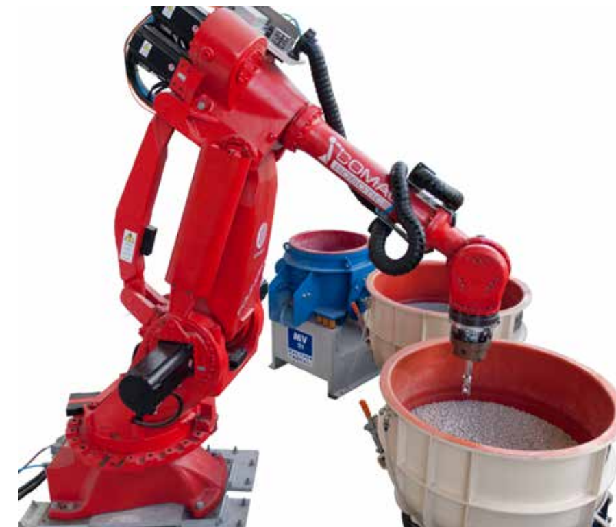
Robotergeführtes Tauchgleitschleifen am IWF der TU Berlin
