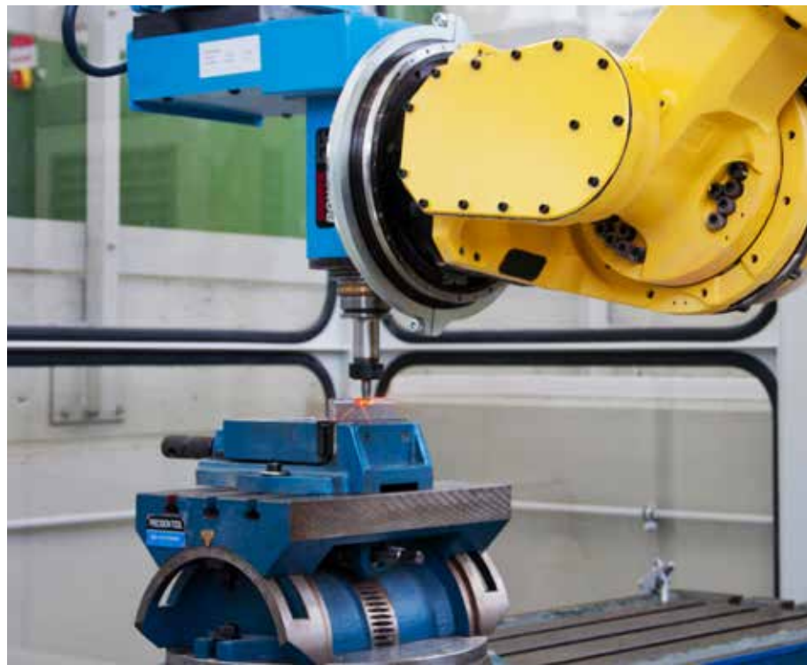
Hochgeschwindigkeitszerspanung von Inconel 718 mit einem Fanuc M-900iB/700
