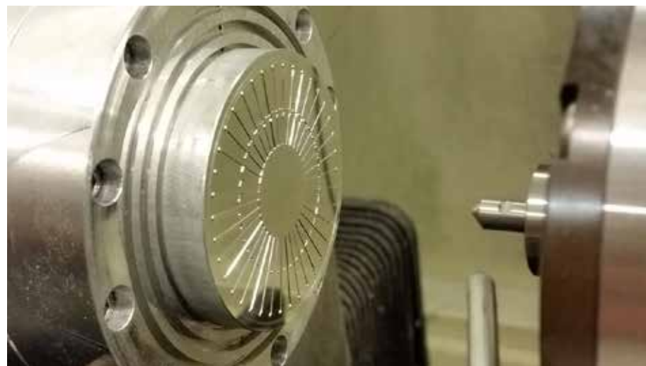
Fertigung eines Abformwerkzeuges zur Herstellung von Blutplasma-Separatoren auf Basis mikrofluidischer Prinzipien mit einer minimalen Strukturabmessung von 15 µm
