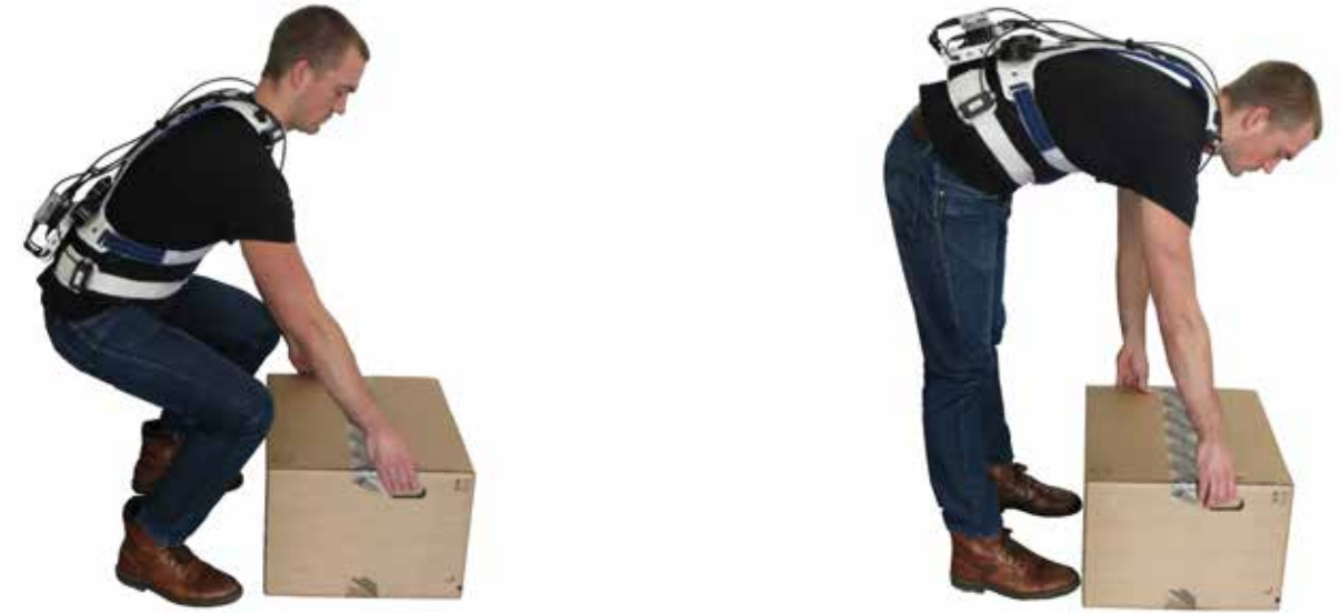
Ergonomische und unergonomische Hehebewegung mit der CareJack-Softrobotikorthese bei der Warenkommissionierung (© Fraunhofer IPK)
